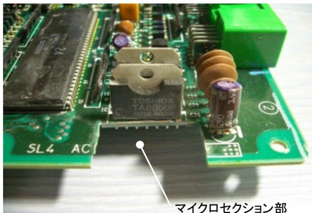
同一形状のパワーIC3ケのうち1個を切断。一見ブローホールに見えるが、恐らくはんだ付時にガスがA面から逃げられず残留したものと思われる。
